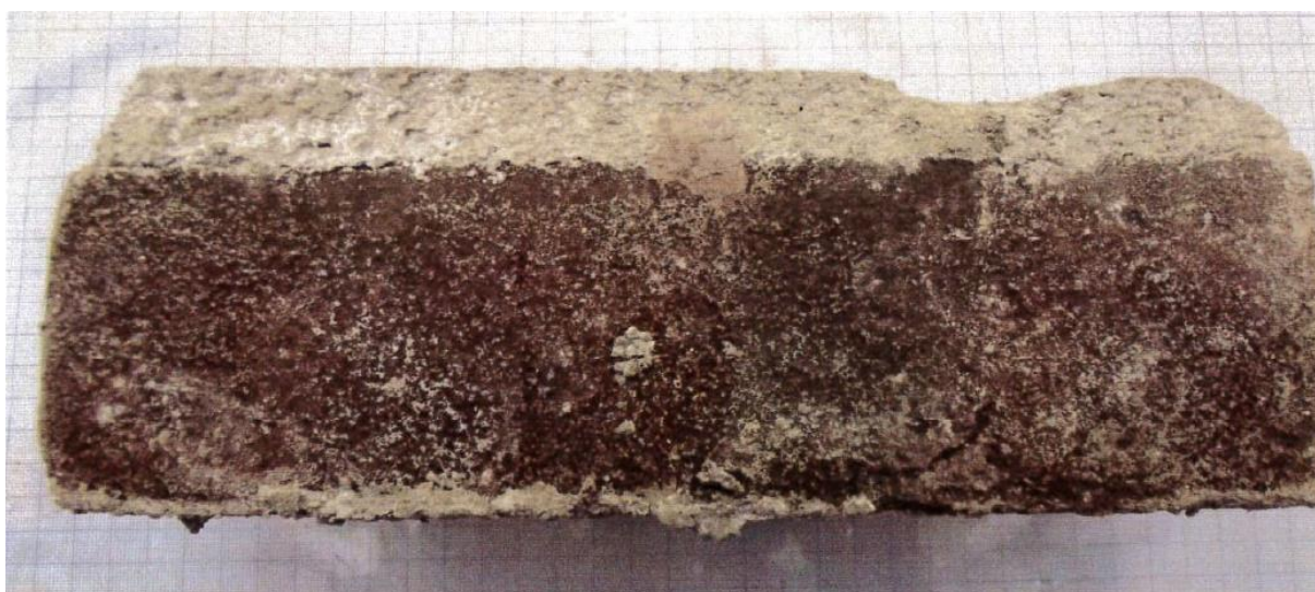
Obr.2 – Ošetrená tehla tesniacou hmotou
